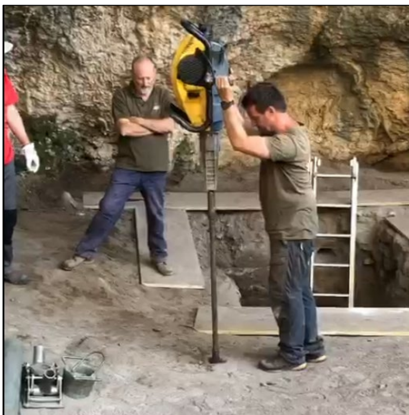
Anexo 20. Sondeo geológico mecánico.
