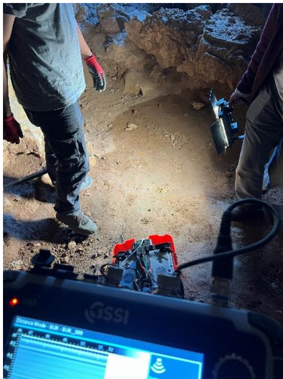
Figura 4. Equipo utilizado en la adquisición de datos de georadar
