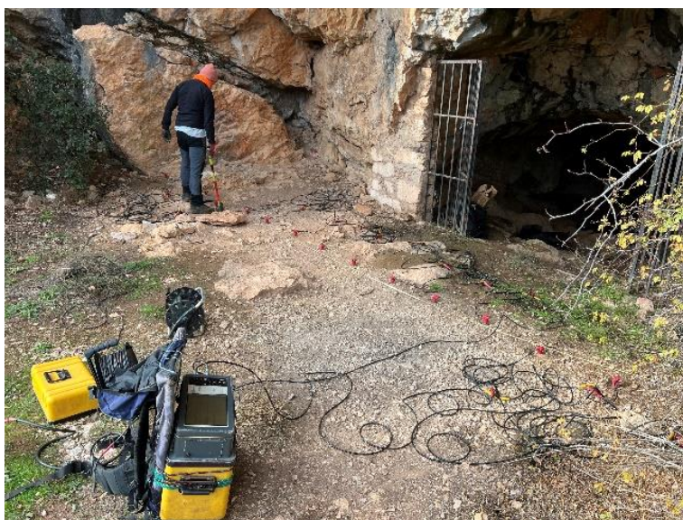
Figura 3. Sismógrafo Smartseis de la casa Geometrics
