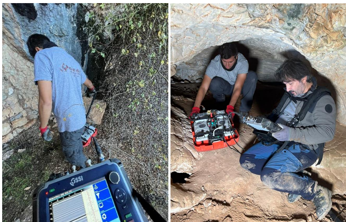
Figura 7. Adquisición de datos de Georadar tanto fuera como dentro de la cueva.
