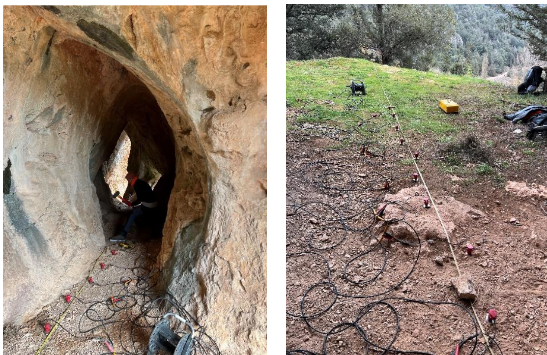
Figura 2. Emplazamiento de perfiles MASW y georadar.
